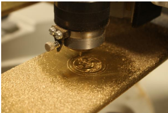
Gravure du logo du Lutetia après usinage du laiton
